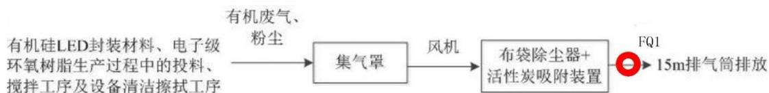
图 7.1-3 废气检测布点示意图
